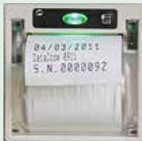
1° Soit l'imprimante basique intégrée à la machine avec étiquettes (auto-collantes) indiquant la date + le N° de série du lot emballé.
