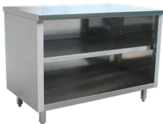
Réalisation inox AISI 441 finition brossée et polie - Top renforcé et insonorisé - Intégralement fabriqué en double plis écrasés - 4 Pieds inox réglables (avec vérins et semelle en PVC - Rails et pièces de suspension tout inox H900mm
