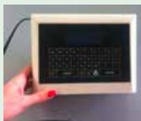
2° Rajouter à l'imprimante intégrée avec un écran LCD externe à la machine et qui permettra de personnaliser l'étiquette avec par exemple du texte pour les matières mises sous vide et cela jusqu'à 20 programmes.
